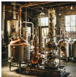
Obr. 25 Průmyslová výroba alkoholu je založena na destilaci
